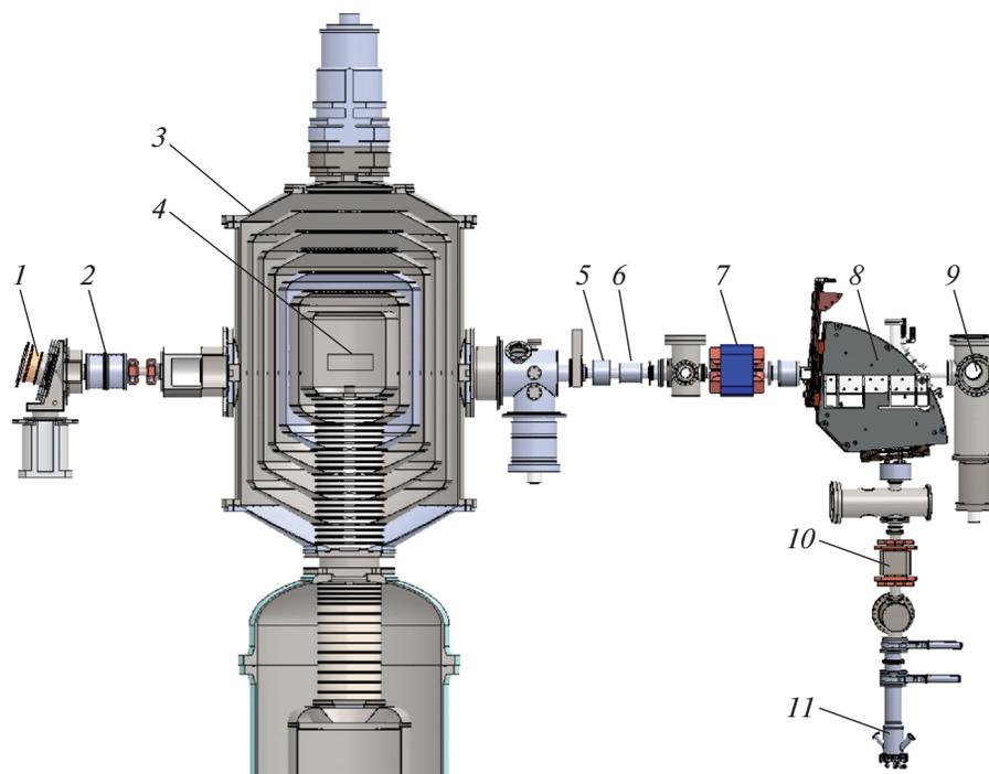
**Рис. 1.** Схема ускорительного источника эпителиевых нейтронов. 1 – источник отрицательных ионов водорода; 2 – магнитная линза; 3 – ускоритель-тандем с вакуумной изоляцией; 4 – газовая обдирочная мишень; 5 – охлаждаемая медная диафрагма; 6 – бесконтактный датчик тока; 7 – корректор; 8 – поворотный магнит; 9 – вторая диагностическая камера с вводимым цилиндром Фарадея; 10 – сканер для развертки пучка протонов; 11 – нейтроногенерирующая мишень.
