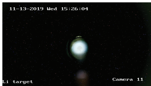
Рис. 4. Свечение, регистрируемое видеокамерой Hikvision при облучении литиевой мишени пучком протонов.
