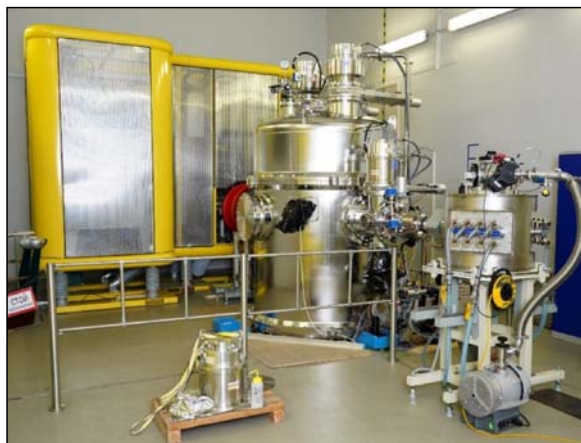
Рис. 2. Ускорительный источник нейтронов VITA-II \alpha на площадке ИЯФ СО РАН перед отправкой в Китай
